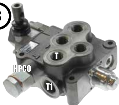
Lukket senter funksjon: HE 15130 monteres i HPCO uttak. Retur fra T eller T1
